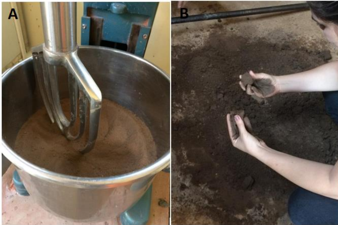
Figura 3 - (A) Mistura solo cimento na Argamassadeira. (B) Análise da umidade ótima.
