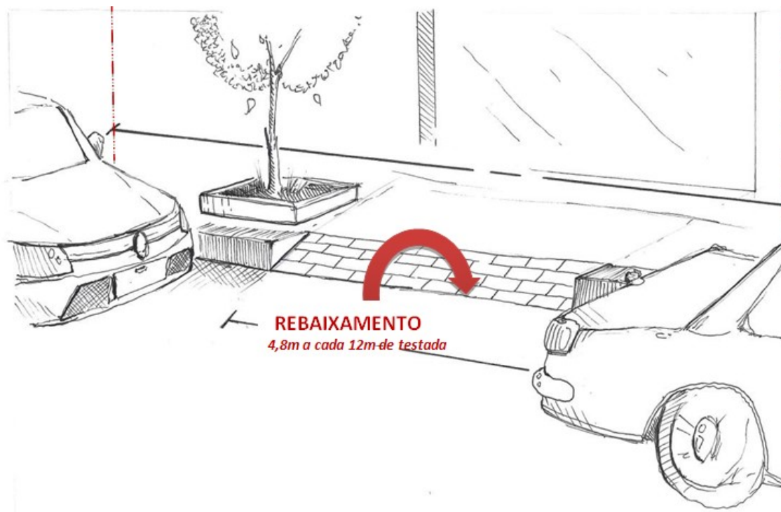
Figura 58 – Demonstração de correta execução do rebaixamento de meio fio. Fonte: Elaborado pela autora.
